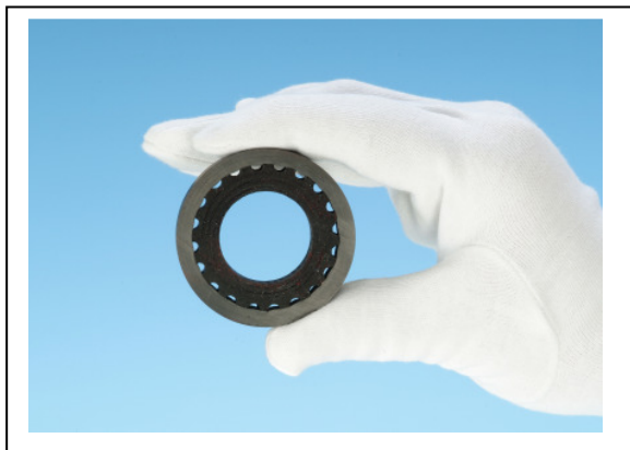
Abb. 1: Prinzipsegment (30 mm Innendurchmesser) der keramischen Brennkammer (innen: CMC, außen: FVK).
