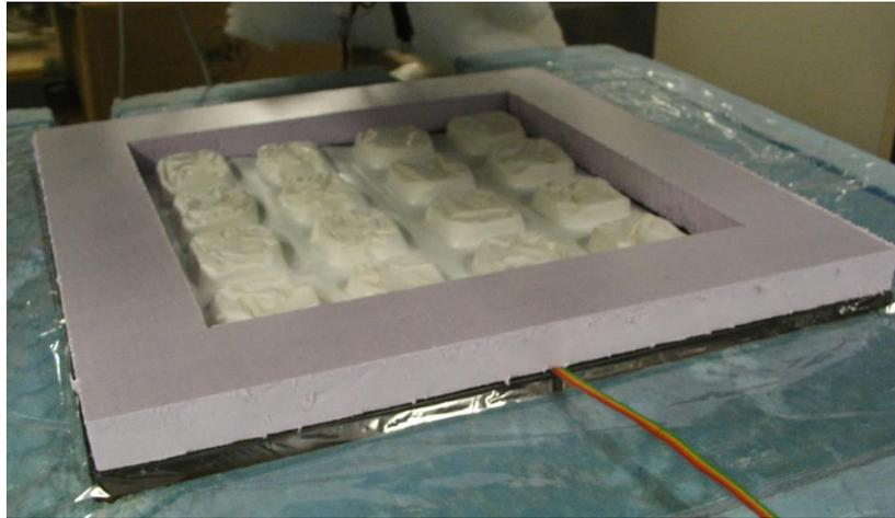
Experimentelle Bestimmung der effektiven Wärmeleitfähigkeit eines Systems mit makroverkapseltem PCM (©ZAE Bayern)
