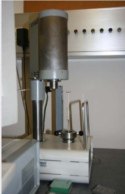
Bestimmung von spezifischer Wärmekapazität und Temperatur während kontrolliertem Aufheizen und Abkühlen
